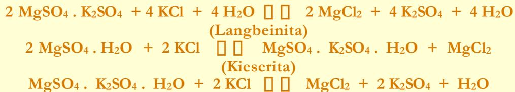
El sulfato de potasio es separado por centrifugación y secado.
